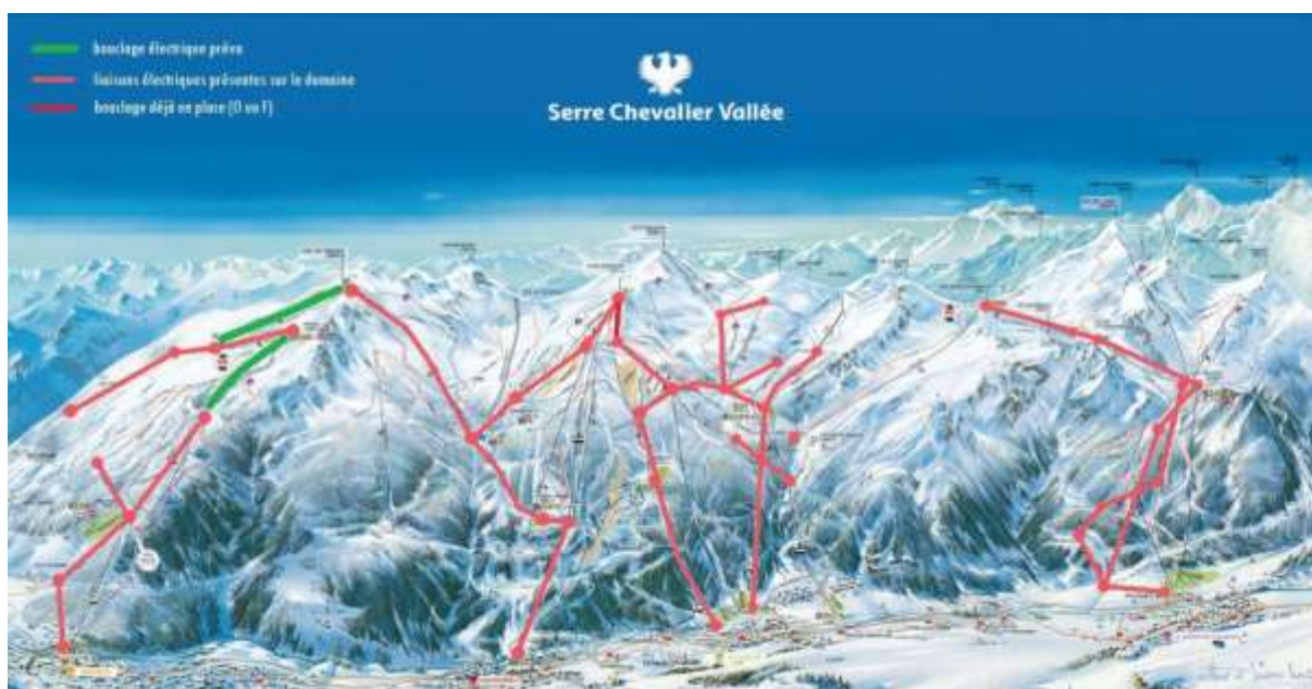
Annexe 4. Représentation du réseau électrique sur le domaine. Configuration prévue en bouclage + pilotage.
