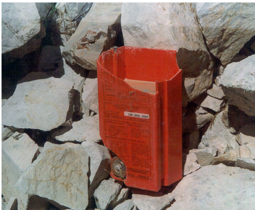
Bloc d'alimentation de la balise de détresse retrouvée sur le site
